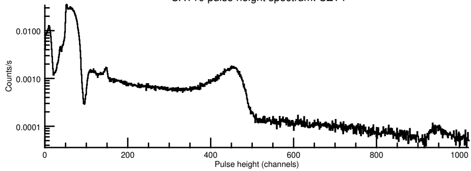
CAT10 pulse height spectrum: CZT4
